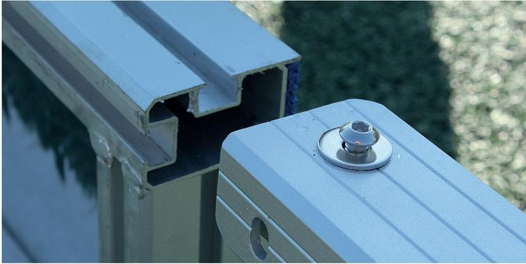
Dann die Laufflächen in die Schienen schieben. Die Nuten an den Laufflächen und die Führungsstangen an den Schienen zeigen genau, wie es zusammen passt.
