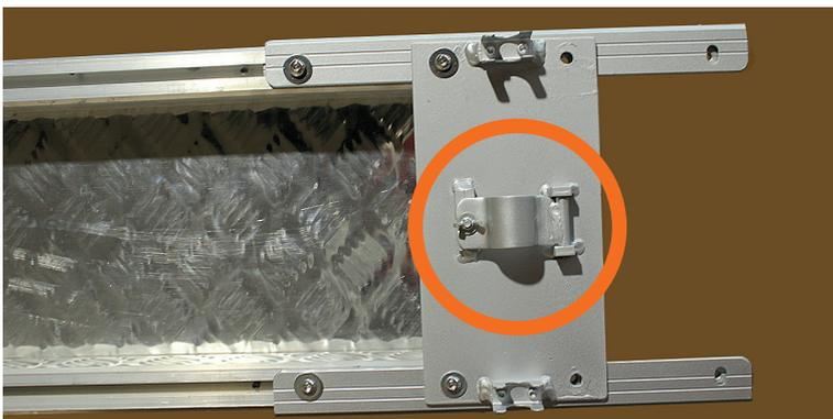
Im nächsten Arbeitsschritt unbedingt mit 2 Personen die komplette Lauffläche mit dem rot markierten Verschluss auf den Standfuß setzen. Dabei muss die Lauffläche genau in der Flucht vom Standfuß sei, darf nicht verkanten.
