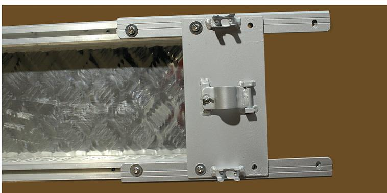
Jetzt die Bodenplatte mit den Schienen verbinden. Dafür die 2 mittleren Löcher verwenden, dass die Platte in der Mitte sitzt. Hier sind keine Unterlagscheiben vorgesehen.
